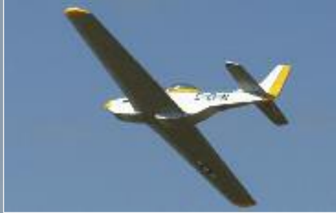
▲ Markus' P-51 D »Mustang« stammt weitgehend aus einem House of Balsa-Bausatz, lediglich das Profil wurde an die Belange eines Hangseglers angepasst. Die »Miss Molly« ist dadurch sicherlich kein Leichtgewicht geworden, aber bei entsprechendem Auftrieb verfügt das Modell über einen ziemlich großen Spaßfaktor.
